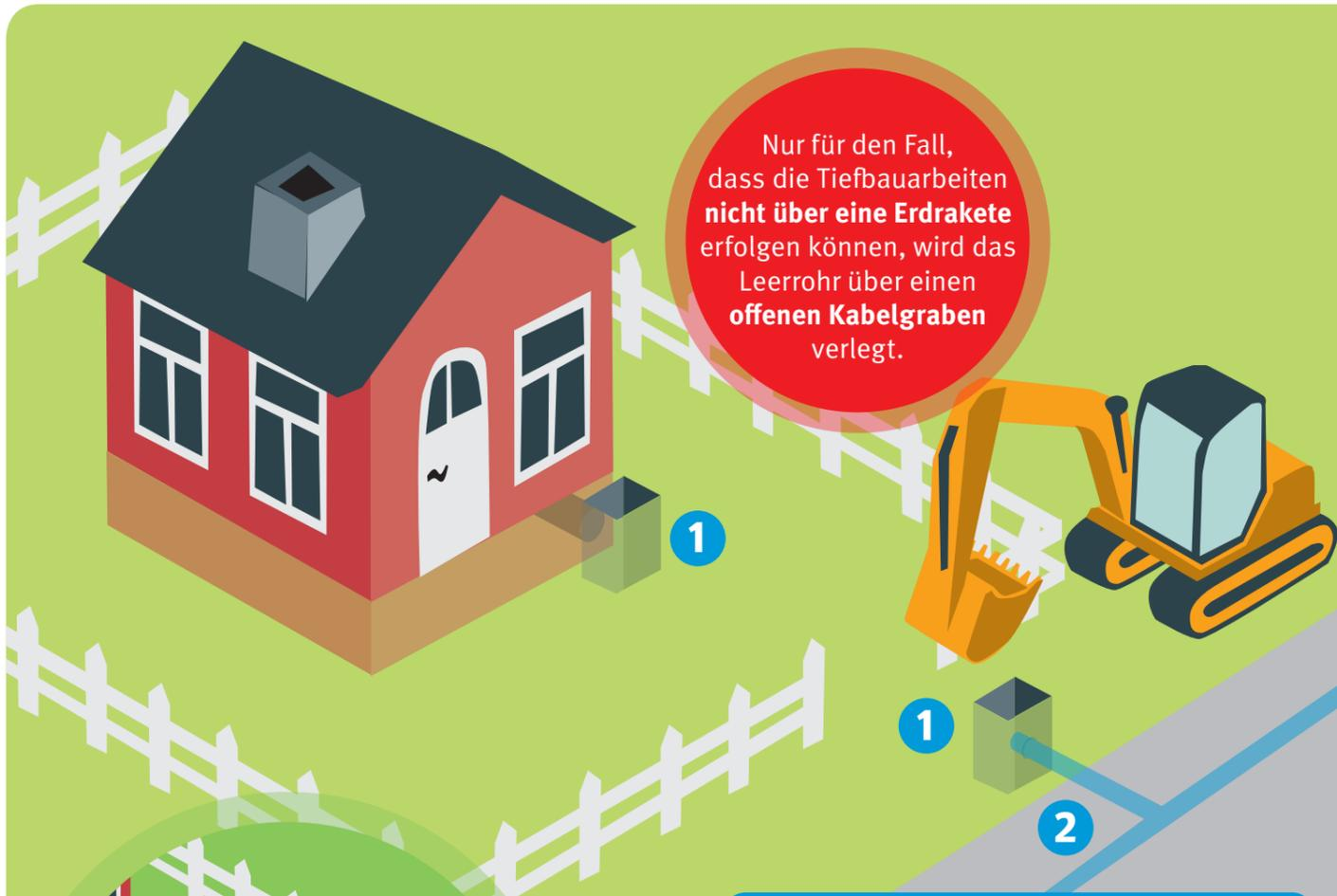
Nur für den Fall, dass die Tiefbauarbeiten nicht über eine Erdrakete erfolgen können, wird das Leerrohr über einen offenen Kabelgraben verlegt.
