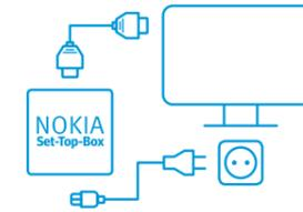
Schließen Sie die Android Nokia Set-Top-Box mit dem Netzteil an eine Stromquelle an und verbinden Sie die Box via HDMI-Kabel mit Ihrem Fernsehgerät.
